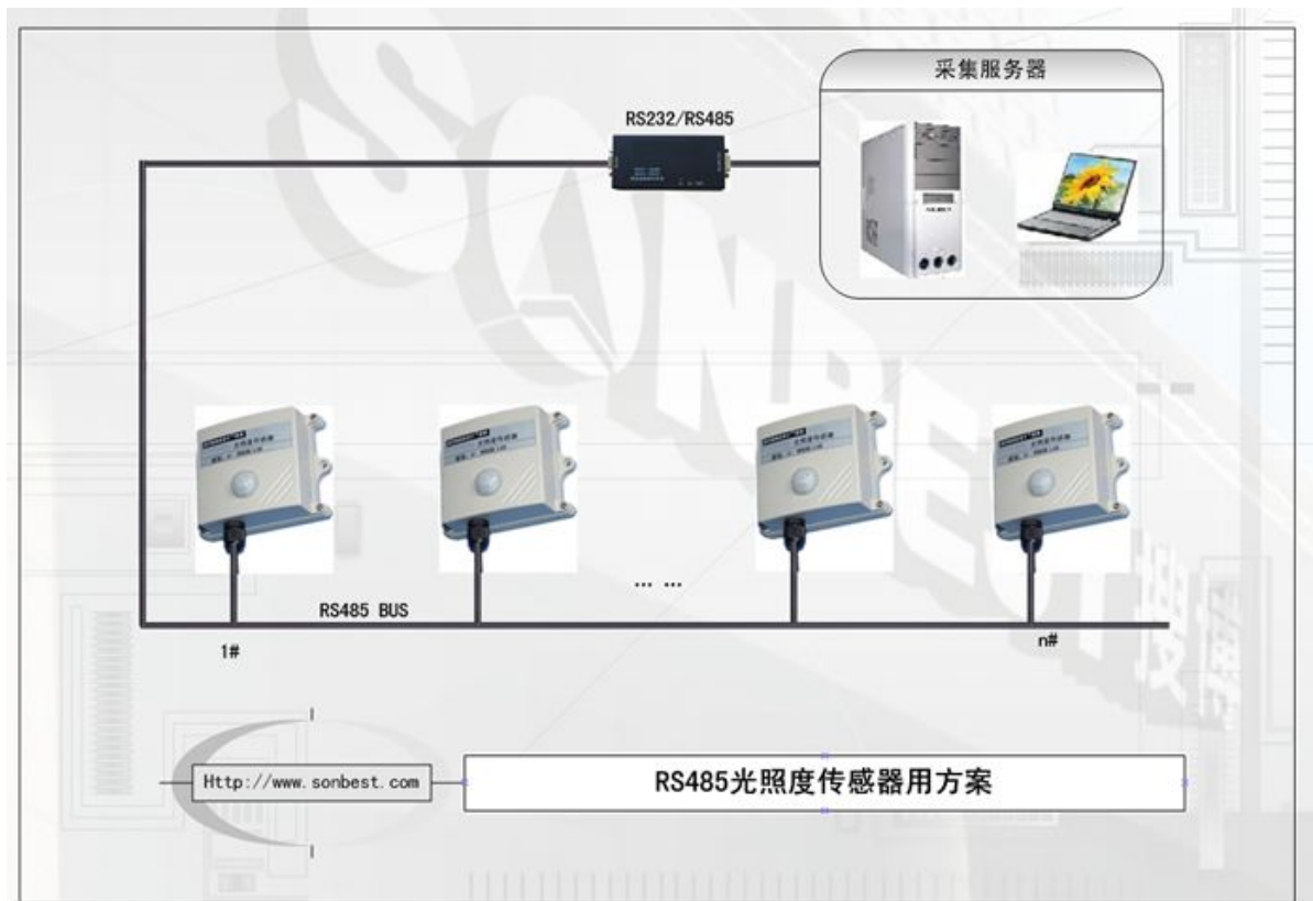
图 1.1 测光照度原理示意图
