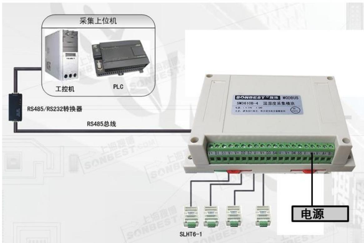
SM3610B-4 可以直接接 4 个温湿度传感器，可以直接与 SLHT 系列各种传感器相连接。图示举例与 SLHT6-1 壁挂式温湿度传感器相连接。模块与传感器之间的引线距离最长可达 50 米。SM3610B 与上位机之间为 RS485 总线，距离最远可长达 1200 米。因模块电源电压为 6-24V 宽范围，故可远程供电，组网更方便。
