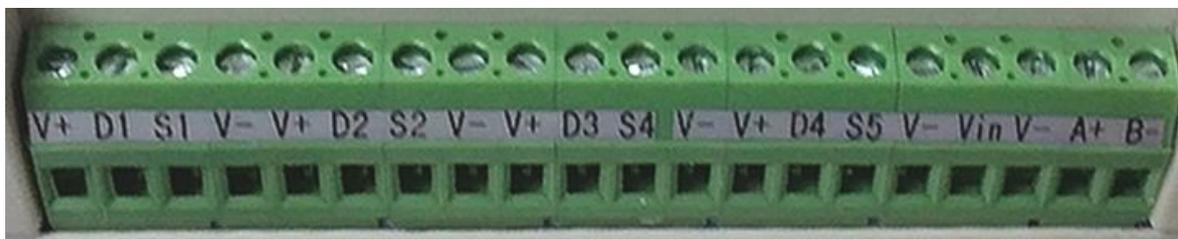
设备自带了 20 芯的接线座，左边 16 芯为传感器接线座，分为 4 个通道，每个通道 4 个引脚。右边 4 芯为电源及 RS485 接线座
