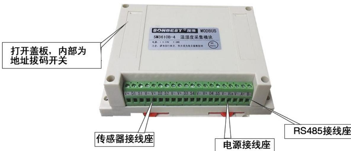
如上图所示, 设备由电源接口、RS485 通讯接口、传感器接线座、状态指示灯、波特率及设备地址设置拨码
