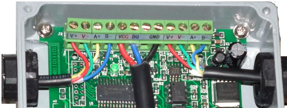
传感器总线为三芯黑色引线，用户可以根据需求自行延长，建议使用三芯电缆或五类双绞线（只需使用其中三芯），模块引出的单总线线芯颜色及与传感器接线引脚定义如下表格所示：
