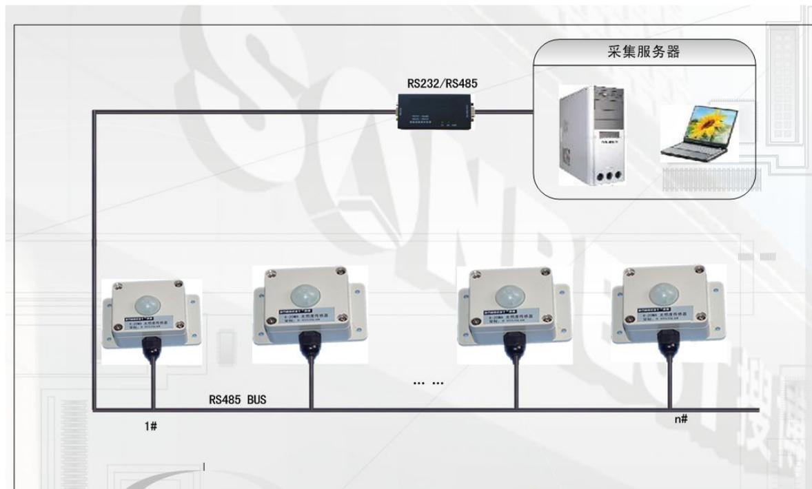
SM3560B 通过 RS485 总线的组网方式,可以将通讯距离延长到最长 1200 米,可以有效解决最简连接的距离过短问题。
