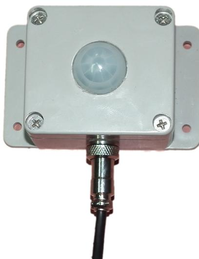
**SM3560B 光照度传感器为 RS485 总线式光照度传感器，采用 RS485 接口，标准 MODBUS-RTU 协议，可实现多点同时监测，组网并远传。**
