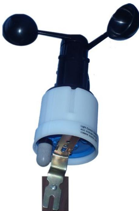
SM5390B RS485 风速、光照度、温度、湿度一体传感器为 RS485 总线式传感器，是针对农业生产过程中环境监测而设计的专用传感器，内置核心传感器全部为进口器件。仪器能够连续监测风速、光照度及环境温湿度等 4 种环境参数，每个参数值都转换成 MODBUS-RTU 标准 RS485 电信号传输给关联设备。
