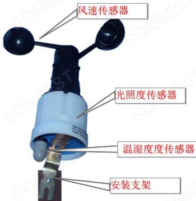
如上图所示，产品由风速传感器、光照度传感器、温湿度传感器、安装支架等几部分组成。
