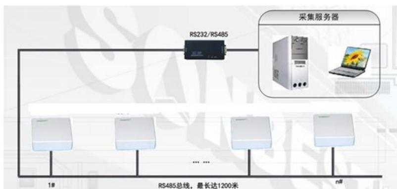
SM5190B 通过 RS485 总线的组网方式, 可以将通讯距离延长到最长 1200 米, 可以有效解决最简连接的距离过短问题。
