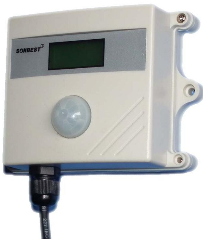
**DB485 系列光照度变送器为 RS485 总线式光照度变送器，采用 RS485 接口，标准 MODBUS-RTU 协议，可实现多点同时监测，组网并远传。**
