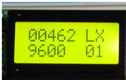
如上图所示，显示器共分为2排，上排显示光照度值，下排显示通讯信息，9600为波特率，01为设备地址，当设备地址拨码开关更改时，新的设备地址也会在显示器上自动显示。
