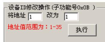
如右图所示，改为后面为目标地址，点击“执行”后，模块即被更改，此时需要修改 MODBUS 设置区的设备地址，才能对模块进行数据查询操作。
