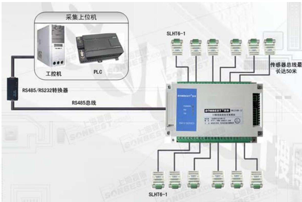
SR1210B-9 可以接 9 个温湿度传感器，可以直接与 SLHT 系列各种传感器相连接。图示举例与 SLHT6-1 壁挂式温湿度传感器相连接。模块与传感器之间的引线距离最长可达 50 米。SR1210B 与上位机之间为 RS485 总线，距离最远可长达 1200 米。因模块电源电压为 6-24V 宽范围，故可远程供电，组网更方便。上述方案适用于实时动态采集，由于设备本身是一款高性价比记录仪，设备可以循环保存 1400 多条记录。即使掉电，掉电前的重要数据都会存储，并可以导出成为 EXCEL 表格。
