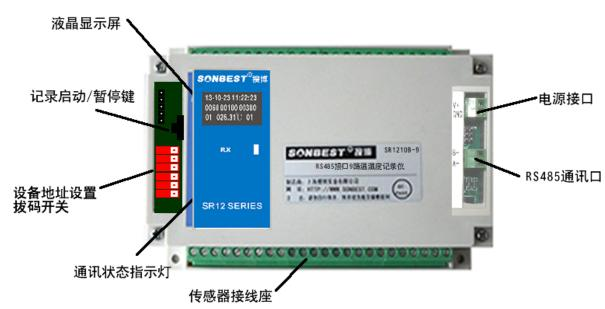
如上图所示,设备由电源接口、RS485 接口、传感器接线座、通讯状态指示灯、记录启动|暂停按键及设备地址设置拔码开关等几部分组成。
