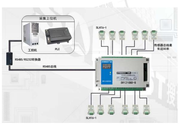
SR1210BD-8 可以接 8 个温湿度传感器,可以直接与 SLHT 系列各种传感器相连接。图示举 例与 SLHT6-1 壁挂式温湿度传感器相连接。模块与传感器之间的引线距离最长可达 50 米。 SR1210BD 与上位机之间为 RS485 总线, 距离最远可长达 1200 米。因模块电源电压为 6-24V 宽 范围,故可远程供电,组网更方便。上述方案适用于实时动态采集,由于设备本身是一款高性价 比记录仪,设备可以循环保存1600多条记录。即使掉电,掉电前的重要数据都会存储,并可以 导出成为 EXCEL 表格。
