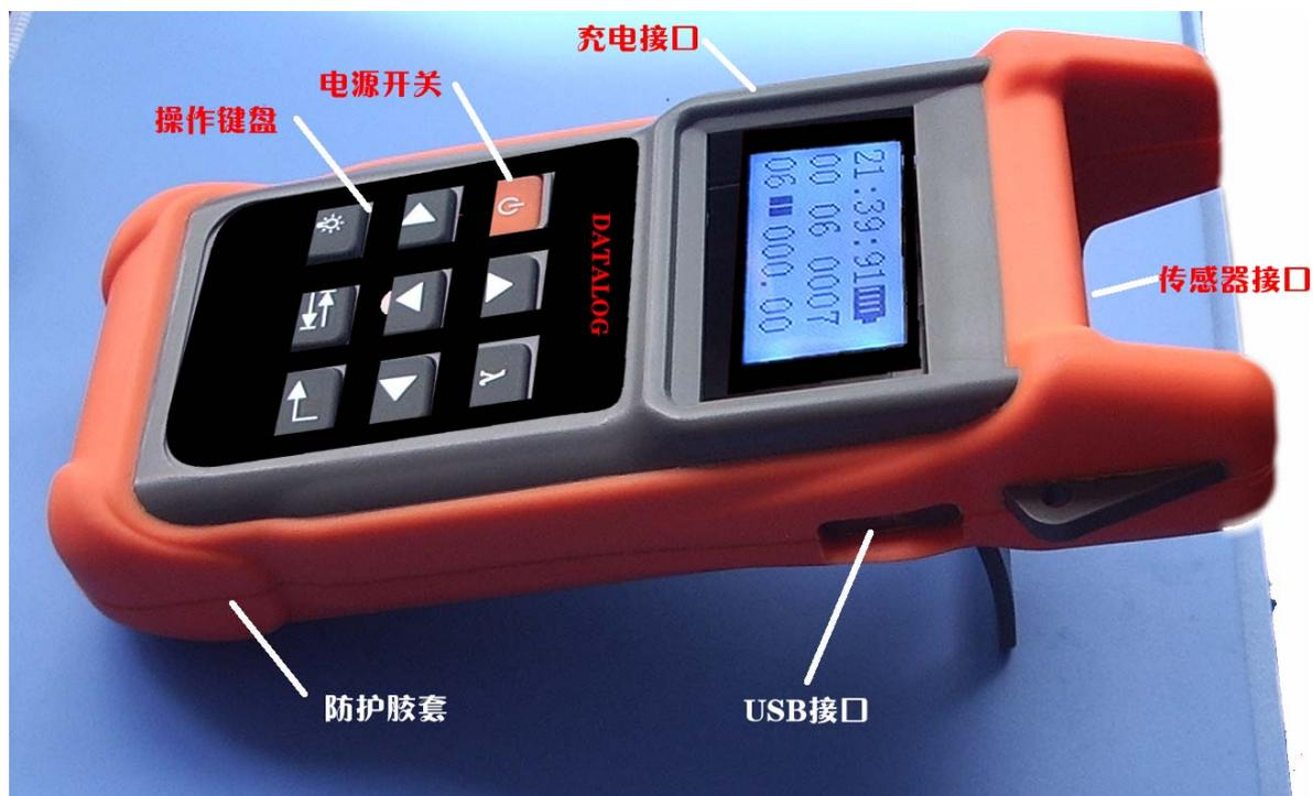
如上图所示，仪器自带充电接口、USB 接口、坚固的传感器接口，外层全方位包胶的外壳，坚固耐用。
